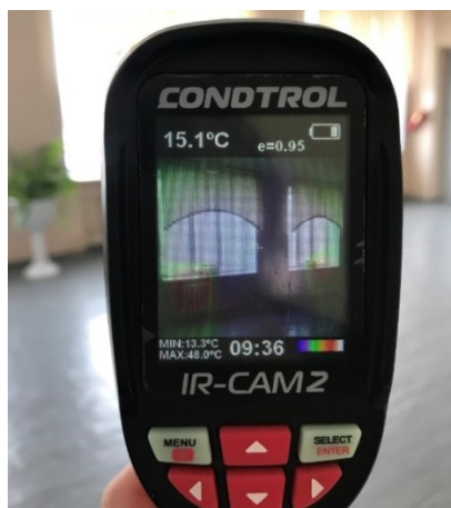
Рис. 1. Тепловизор Control IR-cam 2
