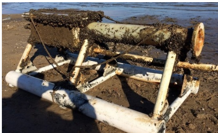
Рис. 1. Водоприемное устройство после одного года эксплуатации
